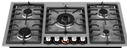
DS 533 سر شعله های SABAF راندمان بالا (HE) دارای Led دور ولوم Size: 890x510 mm Cut: 880x495 mm
